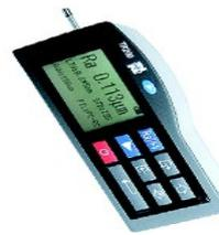
Rugosimetro portatile con tastatore. Ideale per la rilevazione dei valori in luoghi difficilmente accessibili.
