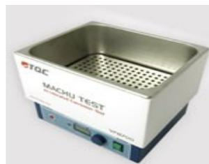
Strumento per effettuare prove di corrosione accelerate su pannelli prova o parti costruttive secondo le normative Qualicoat.
