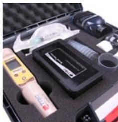
Strumento per la determinazione della contaminazione salina sulla superficie.
