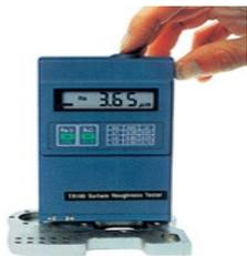
Rugosimetro portatile robusto e maneggevole. Ideale per l'utilizzo sia in laboratorio che in produzione. Secondo le normative ISO e DIN
