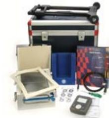
Rileva e registra la temperatura all'interno dei forni. Eccellente sia per l'impiego direttamente in catena di produzione sia per essere utilizzato in prove di laboratorio. Dotato di sonde che vengono applicate direttamente sulla superficie del prodotto rimandando i dati rilevati al registratore e scatola di isolamento a barriera termica. E' disponibile anche con software dedicato per l'elaborazione dei dati.
