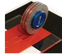
Spessimetro per film umido circolare. Una ruota doppia con nervatura centrale eccentrica viene fatta rotolare sullo strato di vernice umida .
