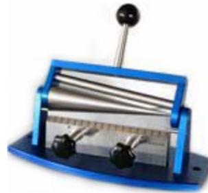
Strumento per determinare l'estensibilità delle vernici applicate su un pannello metallico.
