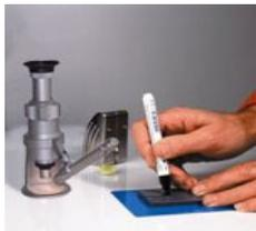
Strumento per la "prova all'impronta", secondo Buchholz. Per valutare la resistenza alla penetrazione dei rivestimenti
