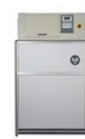
Camere da tavolo per esposizione alla luce xenon per prove accelerate di resistenza solare. Disponibili in 4 modelli: 1500 e 3000, base ed enhanced.
