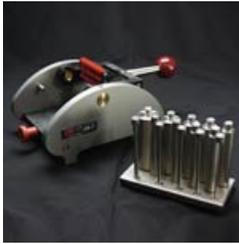
Per prova di piegatura, su lamiere verniciate mediante un mandrino cilindrico di diametro noto secondo la normativa ASTM D552-ISO 1519.
