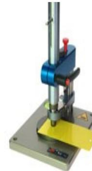
Metodo per controllare la resistenza di vari rivestimenti e superfici di supporto, alla deformazione causata da impatto. Secondo la normativa ASTM D2794 ISO 6272
